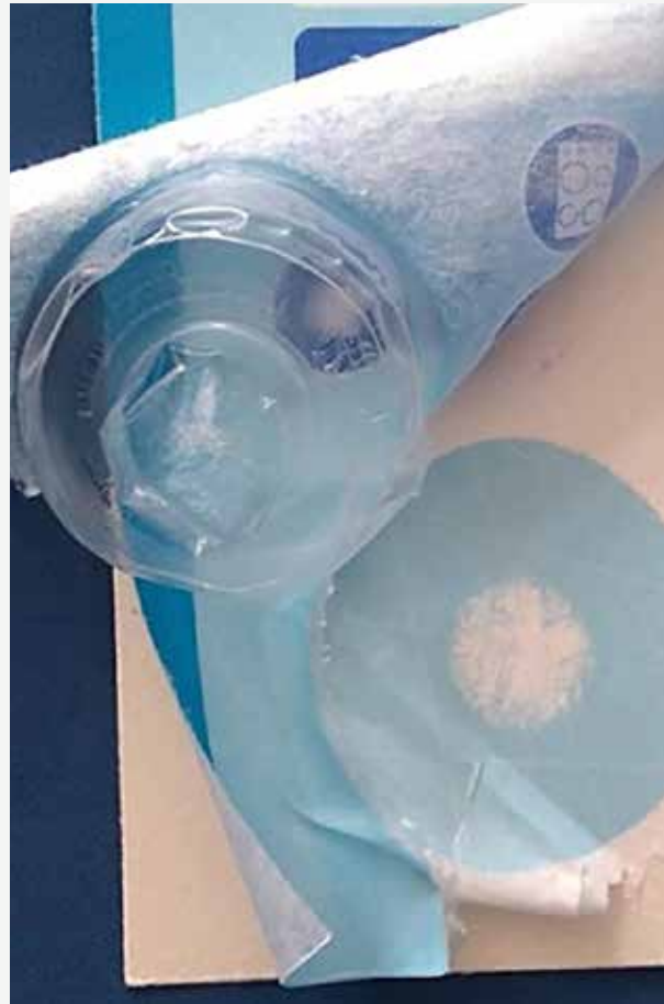
Fot. 2. Opakowanie typu skin pack po próbie rozdzielenia materiałów (na folii widoczne są liczne włókna celulozowe)
